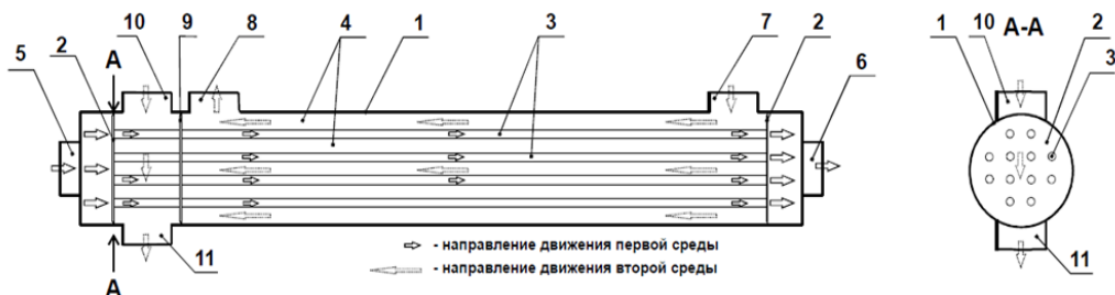
Рисунок 3. Кожухотрубный теплообменный аппарат с дополнительным сектором
